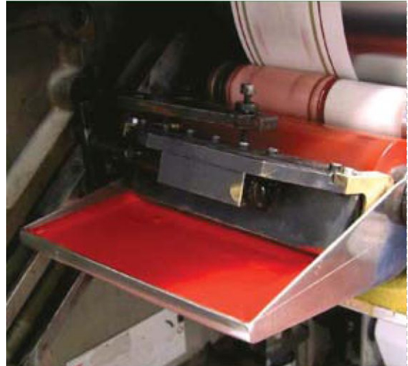
Pembersihan dakwat-dakwat pada silinder percetakan fleksografik
